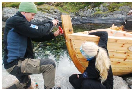
Kine Sagnes og Asgeir Domaas Pedersen gjør klart for bolt gjennom stammen for innspleising av urve som feste for stag.
