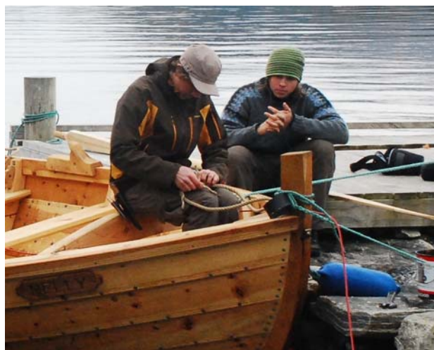
Øyebolten er på plass, og urva kan spleises inn. Det blir denne urva som skal holde staget og sikre at masta ikke havner bakover i vindpress eller hard sjø. Håvard Nesse passer på at Sigbjørn Melvær gjør godt nok arbeid.
